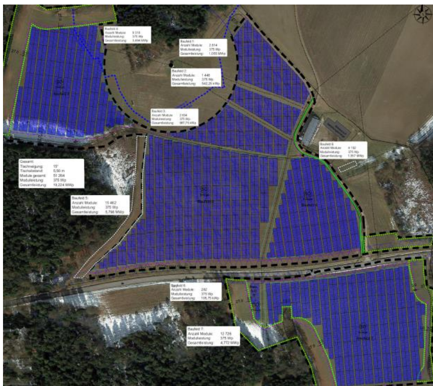
Bild 2: Layout der geplanten PV-Anlage Burghart; Variante mit nach Süden geneigten Modulen
