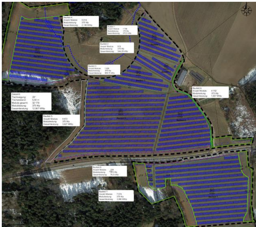
Bild 2: Layout der geplanten PV-Anlage Burghart; Variante mit nach Süden geneigten Modulen
