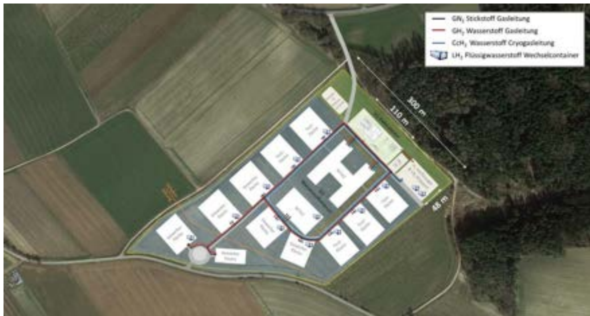
Abb. 5: Grobkonzept zur Verteilung der betrieblichen Nutzungen sowie der Wasserstoffversorgung am Standort (Quelle: HynErgy GmbH, Stand 02/2022)
